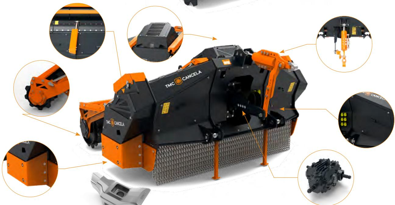
Le MPS et le MPK sont des broyeurs qui intègrent dans une même unité la possibilité de fraiser des souches, des pierres et des racines (jusqu'à 30 cm) en profondeur, ainsi que le broyage de la forêt en surface.
